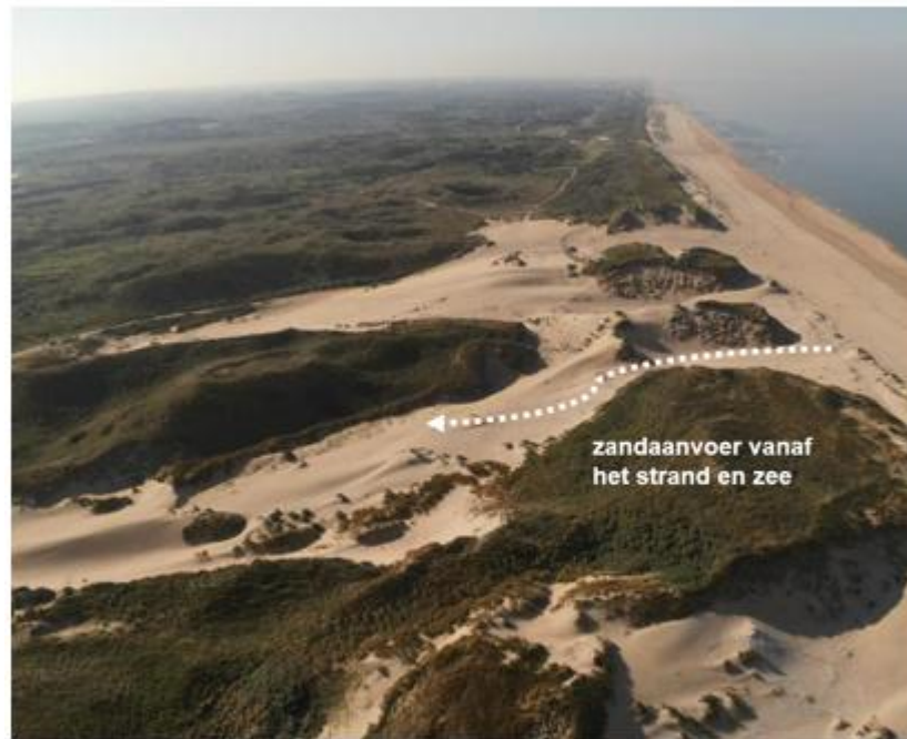
Uit SandTracer (HKV, 2025) – zandtransport van het strand naar het achterland via een kerf langs de Nederlandse kust
